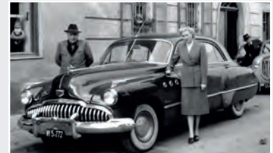
„Buick Super Eight Serie 40, fotografiert am 9. März 1952. Unter der Haube acht Zylinder in Reihen-Aufstellung, jeder mit einem halben Liter Hubraum. Einer der ersten Wagen mit Automatik. Auf der Westautobahn sind wir 100 Meilen schnell gefahren“
